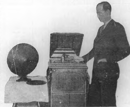
El autor, demostrando el empleo de la unidad reproductora, prueba que es de funcionamiento tan sencillo como el de un fonógrafo ordinario, con la sola diferencia que hay que hacer funcionar un conmutador de filamento.
